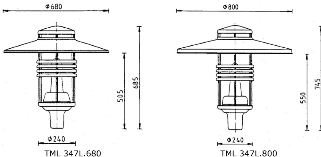
Zur Montage als Aufsatzleuchte auf Stahlmaste bzw. Ausleger (Zopfmaß  $\varnothing$  60/76 mm) oder mit Adapter auf Betonmaste.
